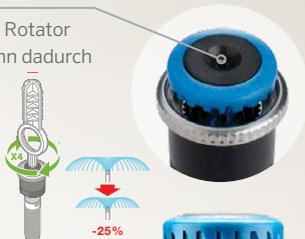
**Wurfsektor Einstellring** Installieren Sie den MP Rotator so, dass die Markierung die linke Begrenzung des Wurfsektors darstellt. Durch das Drehen des Einstellringes nach rechts wird der Wurfsektor vergrößert. Durch die Vergrößerung des Sektors wird auch die Durchflussrate erhöht und dadurch die Niederschlagsrate proportional abgestimmt.
